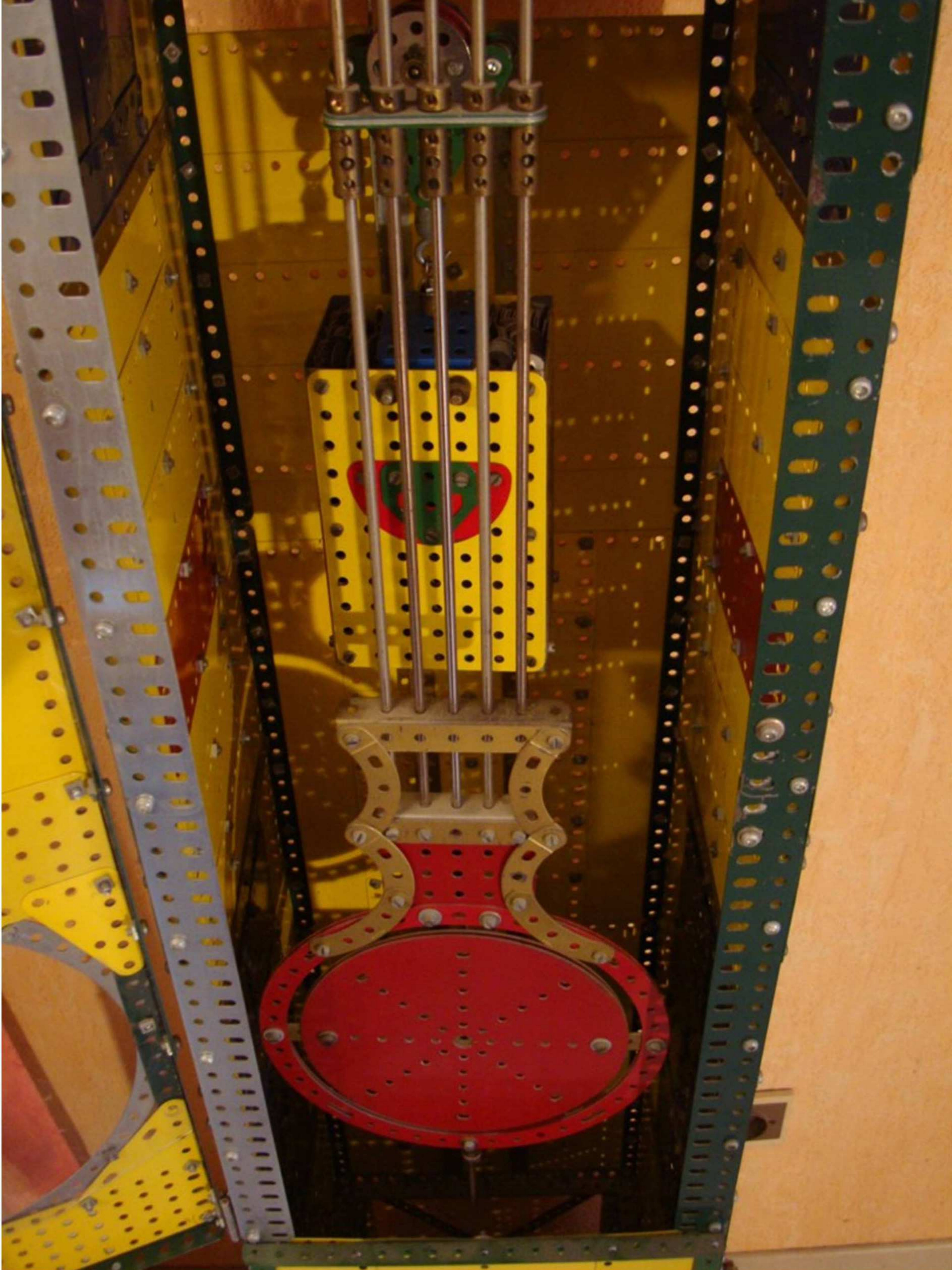
Le balancier et le poids de 2,200 kg, fonctionne environ 24 h entre deux remontages
