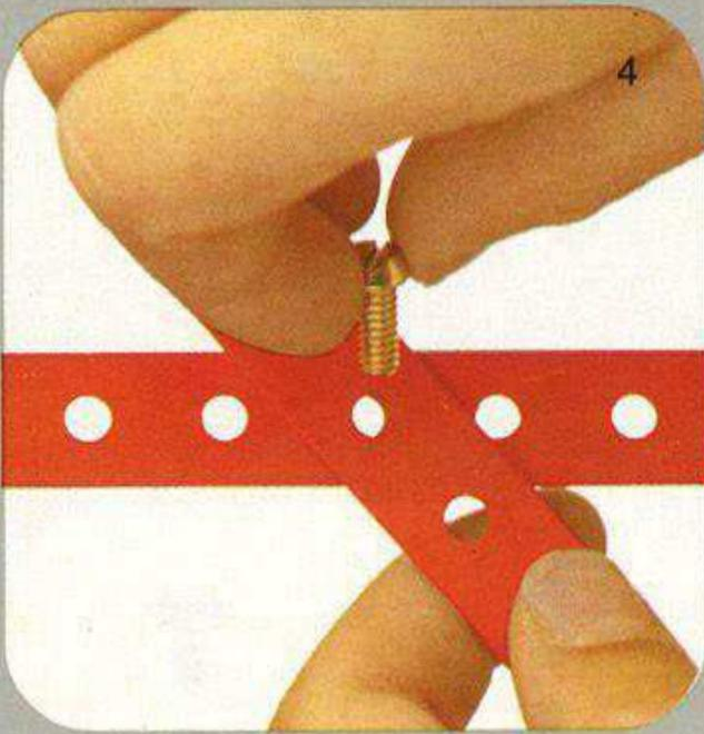
Die Schraube wird durch die Löcher eingeschoben, ...
