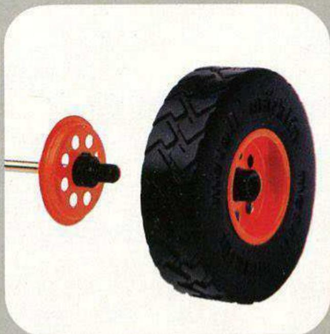
Das Felgenteil mit der Gewindebuchse wird in den Reifen gedrückt und mit der Hand auf die Gegenfelge geschraubt.
