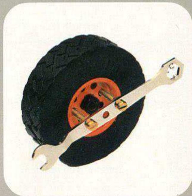
Durch zwei lange Schrauben und zwei Muttern wird aus dem Gabelschlüssel ein Spezialschlüssel. Mit diesem Spezialschlüssel wird das zweite Felgenteil festgezogen.
