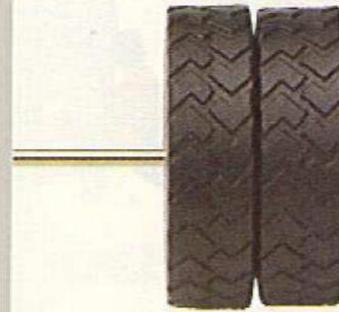
Manchmal ist Zwillingsbeifung erforderlich. Dann wird der zweite Reifen genauso aufmontiert.
