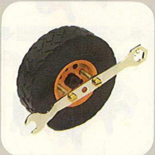
Durch zwei lange Schrauben und zwei Muttern wird aus dem Gabelschlüssel ein Speziälschlüssel. Mit diesem Speziälschlüssel wird das zweite Felgenteil festgezogen.
