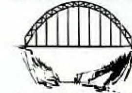
Fachwerkträgerbrücke mit Parabelgurt
