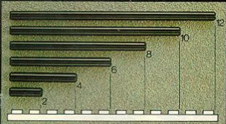
Los números que van al lado de los ejes en las instrucciones de montaje significan el largo del eje que debe utilizarse.
