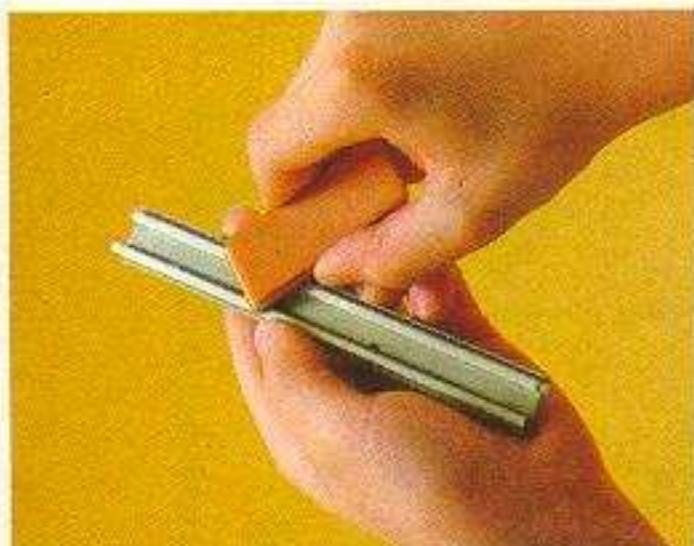
Die Schienen sind regelmäßig mit einem sauberen Radiergummi oder einem leicht in Spiritus getränkten Lappen zu reinigen.
