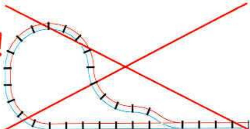
Einige Gleispläne, z.B. die oben abgebildeten, verursachen einen Kurzschluß. Wenn die Gleise kurzgeschlossen sind, schaltet sich die grüne Kontrolleleuchte des LEGO Fahrtreglers aus, bzw. leuchtet nur sehr schwach. Der Zug kann dann nicht fahren.
