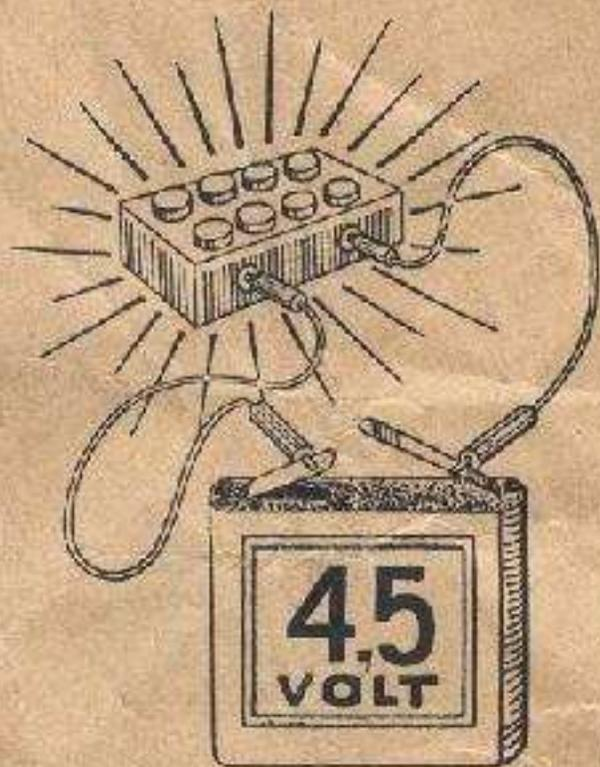
So schließt Du einen LEGO-Leuchtstein an eine 4,5-Volt-Batterie an.
