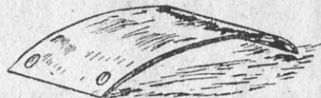
E 20 Dachplatte, gebogen, 30 mm
