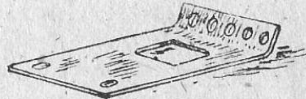
E 15 Seitenwand mit Fenster, 30 mm
