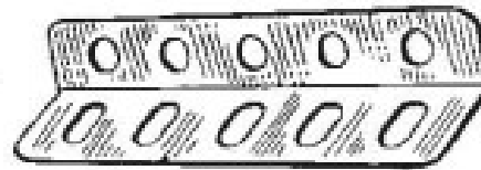
Nr. 24 Winkelstück (Angle) Nr. 24 6 cm 3 Loch (holes) 24a 4,8 cm 4 " " 24b 3,6 cm 3 " "
