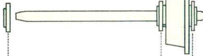
Pour placer un arrêtoir, il suffit de l'engager sur le cône de la broche-essieu et de pousser.
