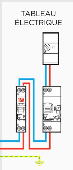
**1** Raccordement électrique SANS contact heures creuses/heures pleines (recommandé)
