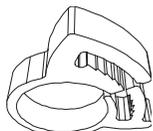
1 Clip de fixation du tube d'évacuation
