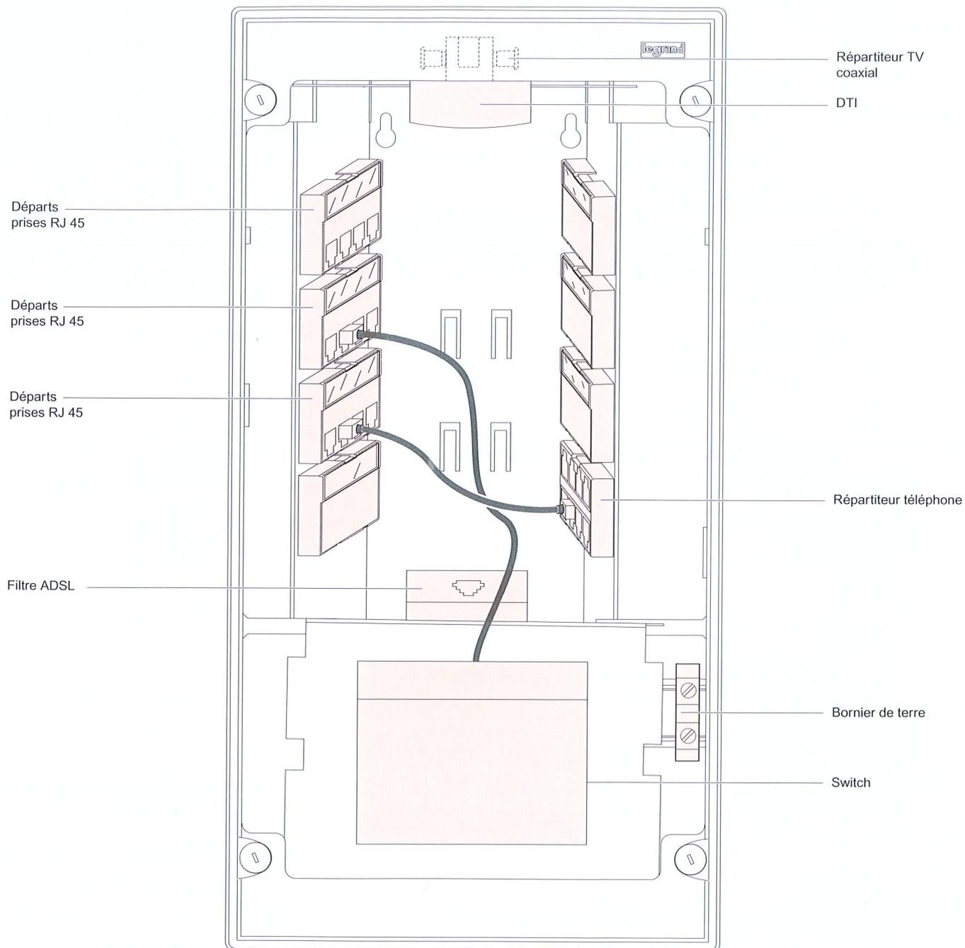
Le coffret réseau mixte permet de créer un réseau de communication vous permettant d'accéder à la **télévision** sur vos prises coaxiales et d'accéder à **Internet** ou au **téléphone** sur toutes vos prises RJ 45.
