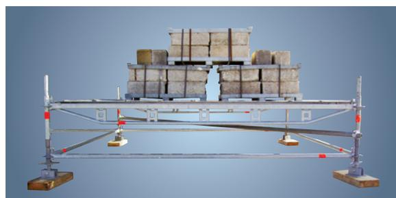
Système Layher sur poutrelle en U sous 1500 kg de charge
