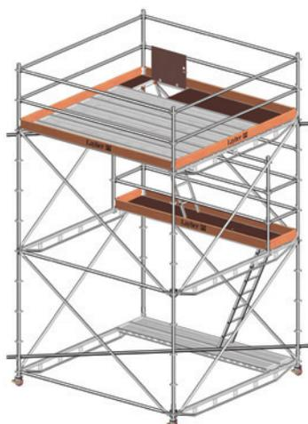
L'échafaudage Universel permet aisément de réaliser tout type d'échafaudage mobile en utilisant une large gamme de galets réglables. Les montants doivent être boulonnés et l'ossature contreventée dans le plan horizontal. Les règles de sécurité applicables aux échafaudages roulants doivent également être observées.
