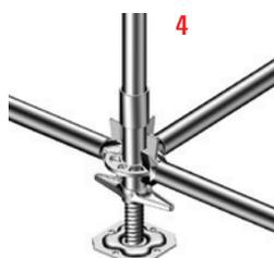
**(4)** Emboîtez les montants, puis, à la hauteur de 2.00 m, raccordez un support plancher en U et des planchers standards munis de joints de sécurité, avec une moise longitudinale.
