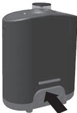
Compartment à piles
