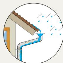
Infiltration en sortie de toiture
