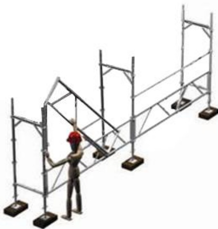
6 - Mise en place des garde-corps repliable MDS à partir du niveau 0 par le niveau N+1. Accrochage du 1 er bras articulé du garde-corps dans les 2 rosaces supérieures puis accrochage du second bras sur les deux rosaces supérieures du portique suivant ; Répéter l'opération sur l'ensemble des mailles du même niveau sur toute la longueur de l'échafaudage ; NB : Il est impossible d'ajouter ou de supprimer une maille horizontale sur la longueur dès lors que les portiques ou montants ont été mis en place à N+1 ;
