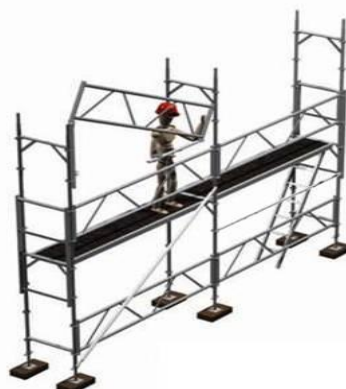
11- Mise en place de la 3 ème lisse au niveau de la maille d'accès.
