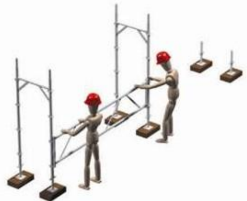
3 - Mise en place des garde-corps standards entre les portiques à une hauteur environ un mètre du niveau du sol.
