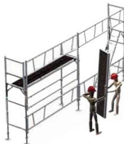
7 - Mise en place des planchers standard depuis le niveau 0 pour niveau N et finir par un plancher à trappe avec échelle pour la maille d'accès
