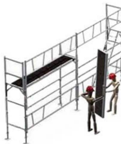
7 - Mise en place des planchers standard depuis le niveau 0 pour niveau N et finir par un plancher à trappe avec échelle pour la maille d'accès
