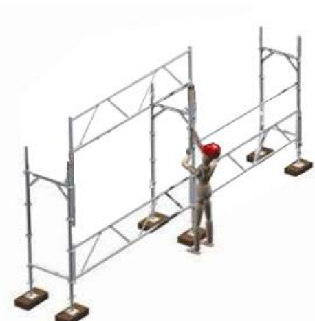
6 - Mise en place des garde-corps repliable MDS à partir du niveau 0 par le niveau N+1. Accrochage du 1 er bras articulé du garde-corps dans les 2 rosaces supérieures puis accrochage du second bras sur les deux rosaces supérieures du portique suivant ; Répéter l'opération sur l'ensemble des mailles du même niveau sur toute la longueur de l'échafaudage ; NB : Il est impossible d'ajouter ou de supprimer une maille horizontale sur la longueur dès lors que les portiques ou montants ont été mis en place à N+1 ;
