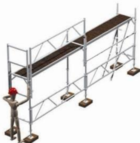
7 - Mise en place des garde-corps d'extrémité monobloc MDS depuis le niveau 0 pour le niveau N+1
