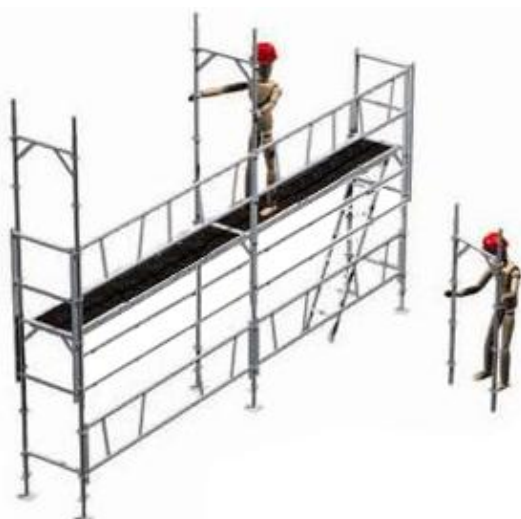
8 - Mise en place des portiques sur tout le niveau N
