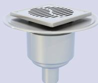
■ 150 x 150 mm ■ Hauteur de réglage : 5 à 45 mm ■ En acier inoxydable avec platine télescopique ■ Évacuation verticale DN50 ■ débit de 0,7 L/s ■ GE 50 mm ■ Couverture Wave 150 x 150 mm verrouillée spéciale pieds nus ■ Fente de 6 mm ■ Finition brossée ■ Accès PMR ■ Tenue à la charge 3 kN
