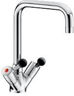
■ Mélangeur monotrou sur plage avec bec tube orientable H 195 L 200 mm ■ Brise-jet étoile, têtes à clapet guidé hors d'eau à mécanisme renforcé ■ Manettes à boule ergonomiques et antichoc ■ Débit 45 L/min à 3 bar, Plein débit en 1/4 de tour ■ Bec à intérieur lisse, corps et bec en laiton chromé ■ Flexibles PEX F3/8", fixation renforcée par 2 tiges inox ■ Garantie 10 ans
