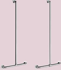
■ Inox 304 bactériostatique poli brillant ■ Utilisation comme barre d'appui et de maintien debout ■ Aide et sécurise l'entrée et le déplacement dans la douche ■ 1 150 x 500 mm ■ Écartement au mur de 40 mm : encombrement minimum interdisant le passage de l'avant-bras ■ Fixations invisibles par platine 3 trous, Ø 72, platines et caches en inox 304, vis inox ■ Marquage CE - Garantie 10 ans
