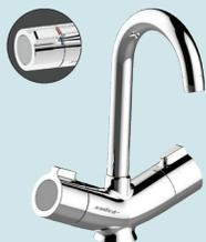
■ Cartouches céramique et thermostatique ■ Brevet MASTERMIX : intercommunication impossible entre l'ECS et l'EFS ■ Double butée de température à 38 et 41° ■ Déverrouillage uniquement par services techniques pour choc thermique ■ Sans vidage
