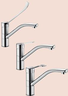
■ Pour évier ou auge à bec orientable H 155 L 230 avec brise-jet hygiénique ■ Cartouche céramique Ø 40, butée de température maximale préréglée ■ Corps et bec à intérieur lisse ■ Débit limité à 9 L/min à 3 bar ■ Commande par levier Hygiène L 200 ■ Flexibles PEX F3/8", fixation renforcée par 2 tiges inox ■ Conforme aux exigences de la norme NF Médical ■ Garantie 10 ans
