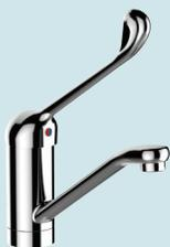
■ Commande au coude ■ Bec tube lisse orientable et fixe ■ Cartouche céramique Ø 40 mm ■ Hauteur sous bec 100 mm, saillie 170 mm ■ Flexibles SPEX, M 10 x 1 ■ Brise-jet étoile, M 24 x 1
