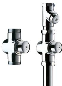
■ Installation murale en applique ■ Temporisation ~7 s, protection antisiphonique ■ Corps et bouton en laiton massif chromé, mécanisme antichoc ■ Alimentation en ligne M1"1/4 ■ Garantie 10 ans
