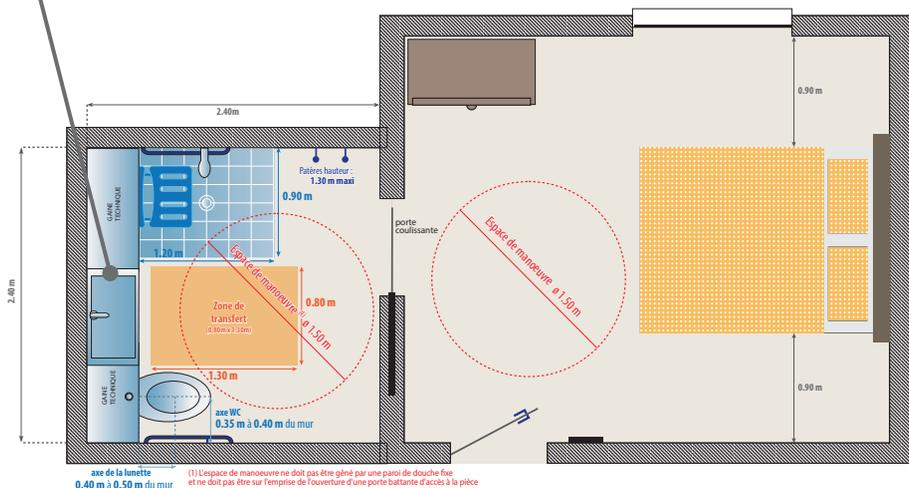
(1) L'espace de manoeuvre ne doit pas être gêné par un panneau de douche fixe et ne doit pas être sur l'emprise de l'ouverture d'une porte battante d'accès à la pièce
