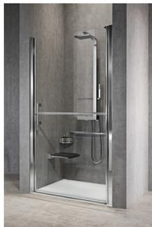
■ Hauteur 195 cm ■ Verre de sécurité transparent épaisseur 6 mm avec traitement déperlant ■ Profilés en aluminium finition silver ■ Ouverture à mi-hauteur pour une assistance facile ■ Accès facile grâce à l'absence de profilé bas ■ Poignée métal ■ Existe aussi avec profilés blanc ou chrome ■ Peut être installée en niche ou en angle avec une paroi latérale Free 1 FGF
