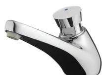
■ Temporisation 15 s ■ Débit 3 L/min réglable ■ Bouton antirotation, évitant tout risque d'usure prématurée ■ Alimentation hydraulique : mâle G 1/2" (15x21) en eau froide ■ Corps en laiton chromé
