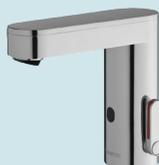
■ Sans contact ■ Débit 3 L/min avec sécurité antiblocage (existe en 1,9 L/min) ■ Butée de température réglable ■ Clapets anti-retour et robinets d'arrêt droits ■ Installation rapide et anti-vandalisme renforcé ■ Détection optimale ■ Pile lithium 6 V CRP2 intégrée dans le corps du robinet ■ Alimentation hydraulique: G 3/8" (12x17) ■ Finition chromée (existe en version capot blanc, noir, ou corps noir et capot or rose)
