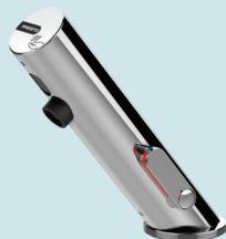
■ Mitigeur électronique sur plage pile ■ Déclenchement et arrêt automatique par détection des mains ■ Débit : 3 L/min à 3 bar avec aérateur régulé intégré anti-tarte ■ Pile lithium 6V CRP2 intégrée dans le corps du robinet ■ Flexibles F G 3/8" (12x17) ■ Corps en laiton chromé, intérieur lisse ■ Capot en métal injecté, chromé ■ Rinçage automatique
