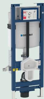
■ WC hauteur réglable ■ Pour WC suspendu, 112 cm ■ Avec réservoir à encastrer Sigma 12 cm ■ Cadre (42,5 x 112 x 17 cm) préparé pour supports des cuvettes de WC avec petite surface d'appui ■ Largeur de cadre réduite pour placer des barres de relevage à côté du bâti-support ■ Cuvette de WC adaptable ultérieurement en hauteur dans la salle de bains terminée ■ 41 à 49 cm à partir du sol fini ■ Pieds supports galvanisés, antidérapants et réglables 0 à 20 cm
