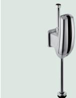
■ Détection infrarouge fiable de la distance ■ Détecteur infrarouge auto-ajustable ■ Temps de rinçage réglable manuellement ■ Rinçage intermittent réglable ■ Ajustement dynamique du temps de rinçage ■ Rinçage préliminaire réglable ■ Rinçage unique après activation de l'alimentation électrique ■ Alimentée par pile ■ Pile en usage dans le commerce de 9 V en lithium ou alcaline possible ■ Chromé mat
