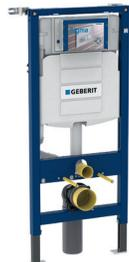
■ Avec réservoir à encastrer Sigma 12 cm (50 x 112 x 12 cm) ■ Pour rinçage simple touche, double touche ou interrompable ■ Pour WC suspendu, rallongés jusqu'à 70 cm ■ Pour WC suspendus avec dimensions de raccordement selon EN 33:2011 ■ Pour montage sur parois d'installation à hauteur du local ■ Pour hauteur de chape de 0 à 20 cm ■ Pieds supports antidérapants ■ Plaques de pieds orientables
