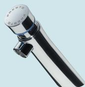
■ Robinet simple sur plage ■ Débit 3 L/min à 3 bars ■ Réglage 4 positions ■ Temporisation 15 s ± 5 s ■ Résiste à une température de 75°C durant 30 min dans le cadre de chocs thermiques ■ Mâle G 1/2" (15x21) en eau froide
