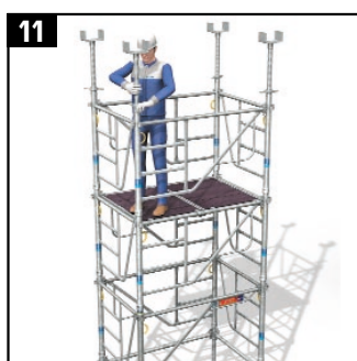
11 • Mise en place et réglage des fourches à vérin.
