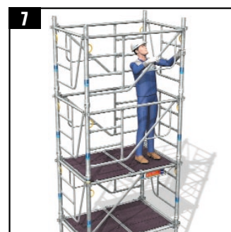
7 • Montage du troisième niveau.
