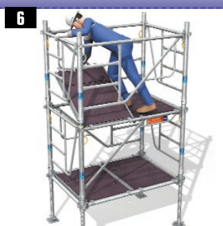
6 • Accès au niveau supérieur. • Pose du second plancher à trappe de 1,00 m.
