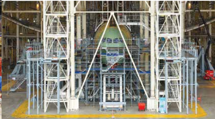
Toulouse : échafaudages pour les tests de résistance sur l'Airbus A350-900.
