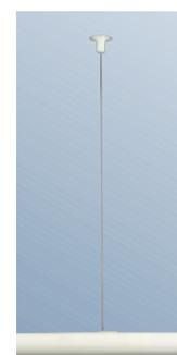
**Suspentes câbles** longueur réglable. Utiliser des suspentes simples pour les montages en ligne et doubles pour les angles et autres jonctions. Espacement max.: 1200 mm. Charge max.: 25 kg.
