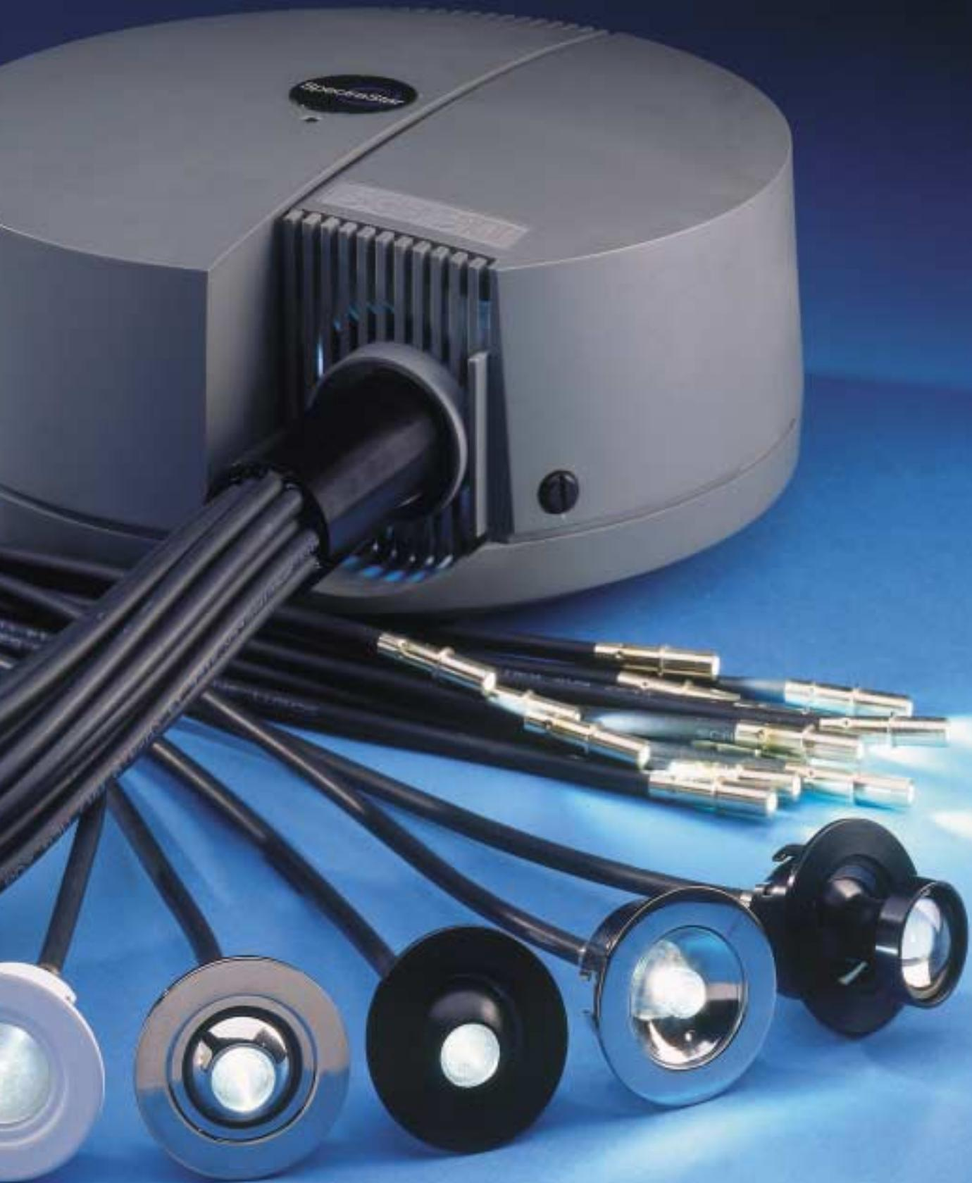
L'utilisation de la fibre optique pour transporter à distance le flux lumineux d'une source révolutionne le concept d'éclairage traditionnel. Le boîtier source est placé là où la maintenance et la sécurité électrique sont assurées aisément. Le parcours des fibres peut se réaliser dans un vide restreint. Selon le nombre de fibres, leur diamètre et leur longueur, le matériau lumineux qu'elles constituent, linéaire ou ponctuel, peut être décoratif ou éclairant.
