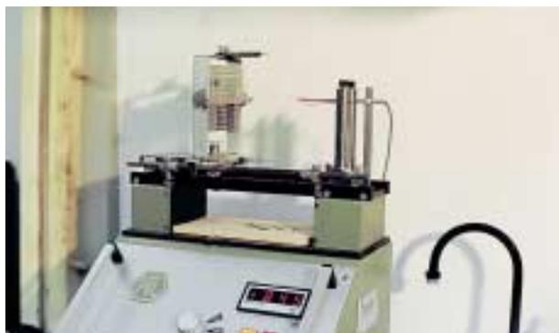
L'aptitude à l'extinction des appareils d'éclairage destinés à être installés dans les établissements recevant du public est vérifiée en effectuant un essai au fil incandescent sur les différentes parties des appareils.
