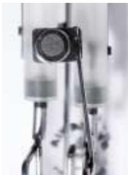
Les nouvelles générations de lampes dite "**Hi-Xénon**" sont équipées d'une antenne extérieure rapportée au niveau du brûleur assurant un amorçage fiable et rapide. Le "getter", dispositif servant à purifier l'atmosphère interne de la lampe est le garant d'un meilleur maintien du flux lumineux dans le temps.
