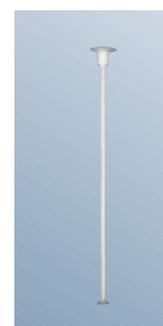
**Suspente rigide** longueur max. 500 mm. Peut être recoupée sur site. Espacement max.: 1200 m. Charge max.: 25 kg.
