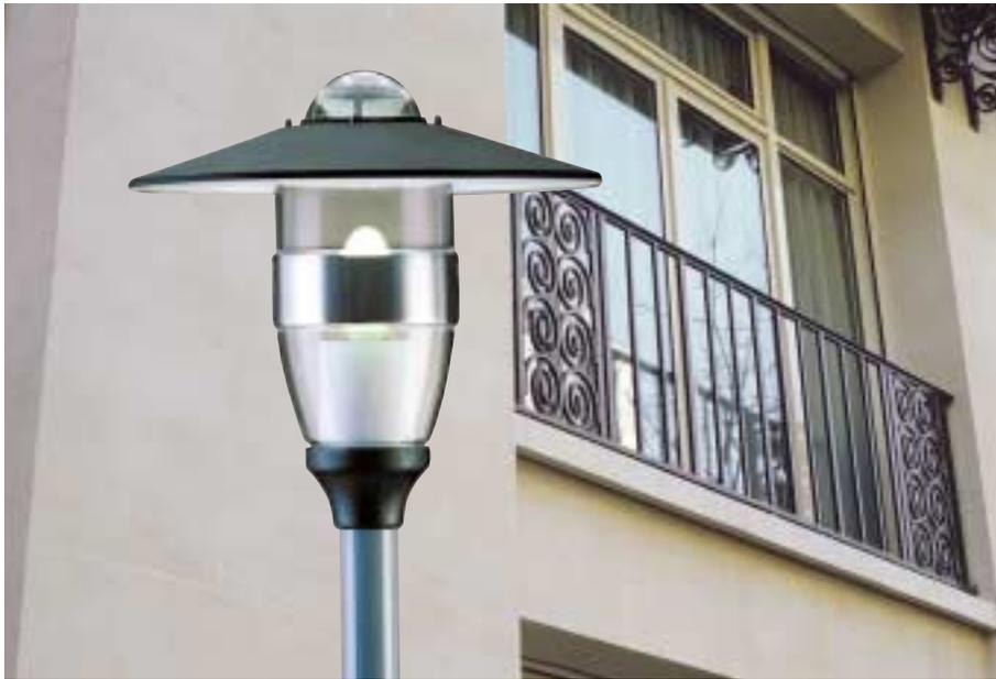
Lanterne au design contemporain constituée d'un diffuseur en polycarbonate clair surmonté d'un chapeau en tôle d'acier traité anticorrosion, peint poudre époxy intérieur blanc extérieur gris anthracite. L'ensemble diffuseur/chapeau se fixe par système baïonnette 1/4 de tour sur une embase classe II. Equipement pour lampes à vapeur de mercure 80/125W ou sodium haute pression 100W. Emmanchement sur fût ou manchon Ø60mm.
