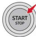
Avec la clé électronique dans l'habitacle, l'appui sur le bouton "**START/STOP**", **sans action sur les pédales**, permet la mise du contact sans démarrer le moteur.
