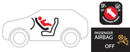
! L'airbag frontal passager doit impérativement être neutralisé avant d'installer un siège enfant dos à la route. Sinon, **l'enfant risque d'être gravement blessé ou tué lors du déploiement de l'airbag.**
