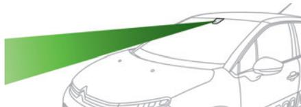
Le véhicule comporte une caméra implantée en haut du pare-brise et, selon version, un radar situé dans le pare-chocs avant.
