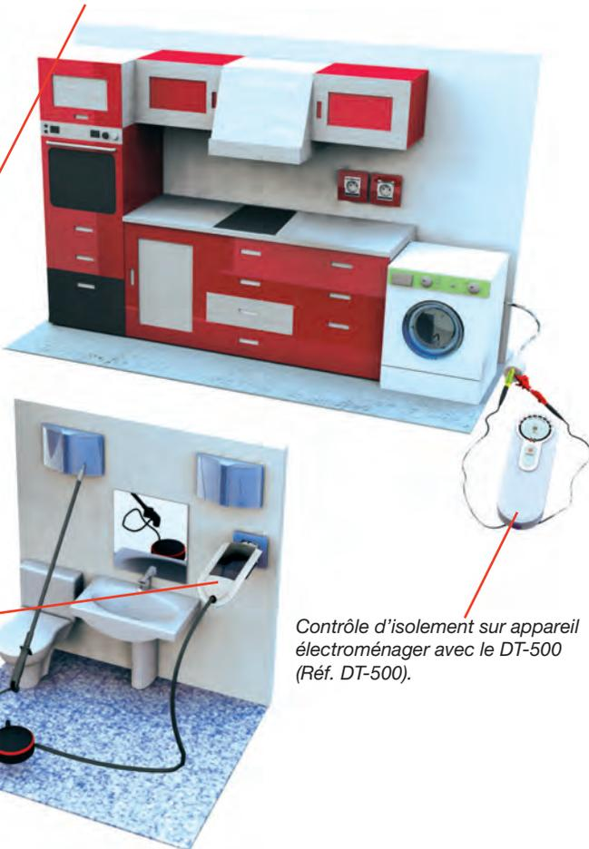
Contrôle d'isolement sur appareil électroménager avec le DT-500 (Réf. DT-500).
