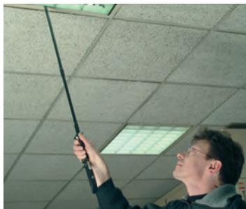
Contrôle de continuité sur plafonnier avec perchette de contact (Réf. M-951143) raccordée au Cathom™ NG.
