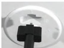
Adaptateur DCL (Réf. M-921546) monté sur perchette.
