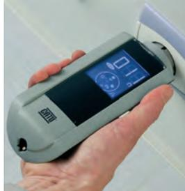
Mesure de la résistance de terre sur prise 2P+T avec le Catohm™ NG (Réf. DT-300).
