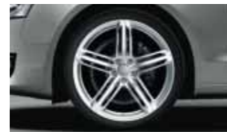
Jantes en aluminium coulé Audi exclusive style 5 branches triples, 9 J x 19 avec pneus 255/35 R 19
