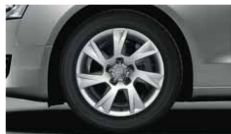
Jantes en aluminium coulé style 7 branches structurées, 7,5 J x 17 avec pneus 225/50 R 17. (De série sur Ambiente)
