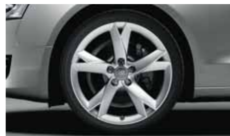
Jantes en aluminium coulé style 5 branches en Y, 8,5 J x 19 avec pneus 255/35 R 19
