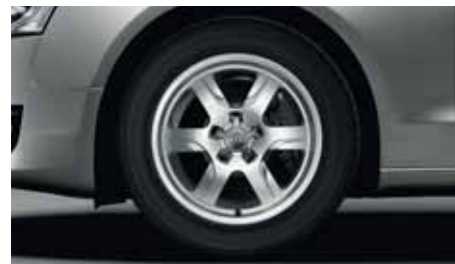
Jantes en aluminium forgé style 6 branches, 7,5 J x 17 avec pneus 225/50 R 17. (De série sur Attraction)
