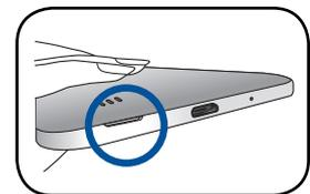
3. Désengagez lentement le couvercle arrière de la coque de l'appareil.
