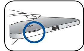
3. Désengagez lentement le couvercle arrière de la coque de l'appareil.
