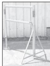
3. Tréteau avec plancher à 1.15m du sol (avec le quarfran réf. 1904).
