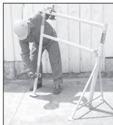
← 2. Montage de la platine femelle (réf. 1901) sur le quarfran (réf. 1904) avec clavetage du collier sur le montant du quarfran.
