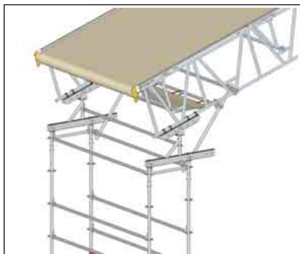
A gauche, fixation de la bâche sous la poutre ALTRIX.
