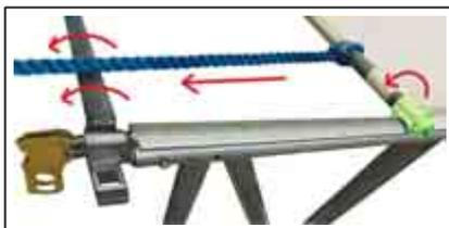
Fixation de la bâche avec des sangles sur un tube ou une lisse suivant le finition. Voir page xx pour les différentes finitions.
