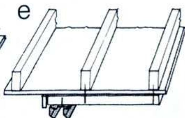
**e** pour le rail sur des plafonds lattés et plâtrés, renforcez votre plafond avant fixation du rail.
