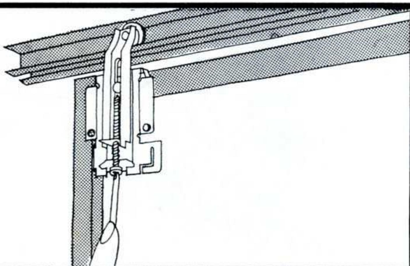
**14** **Réglez les portes** avec un tournevis tête Phillips et rectifiez l'alignement de vos portes avec la vis de réglage sur le galet de suspension. En même temps, réglez l'aplomb de chaque porte par rapport au mur adjacent.
