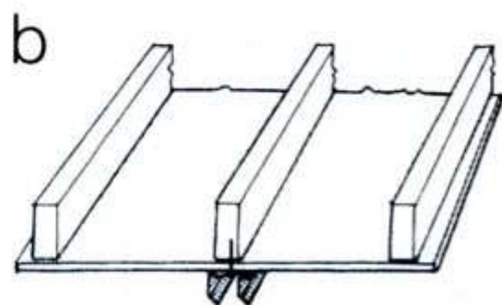
**b** pour le rail se plaçant juste sous la solive, utilisez les trous existants.
