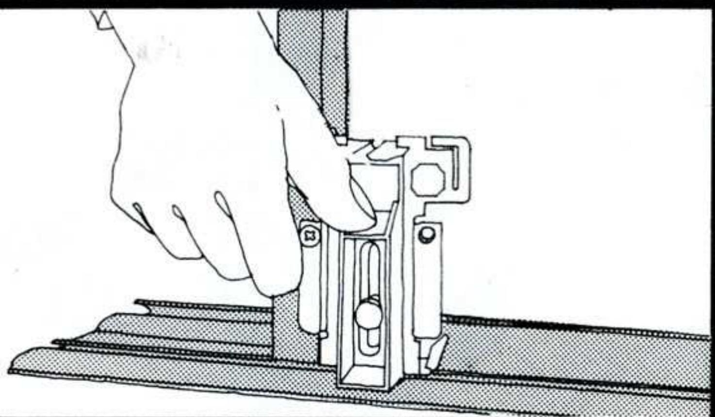
**15** **Pressez le guide dans le rail.** Pressez avec le pouce le guide nylon jusqu'à sa pénétration dans le rail. Le guide montera et descendra pour compenser les irrégularités de niveau.
