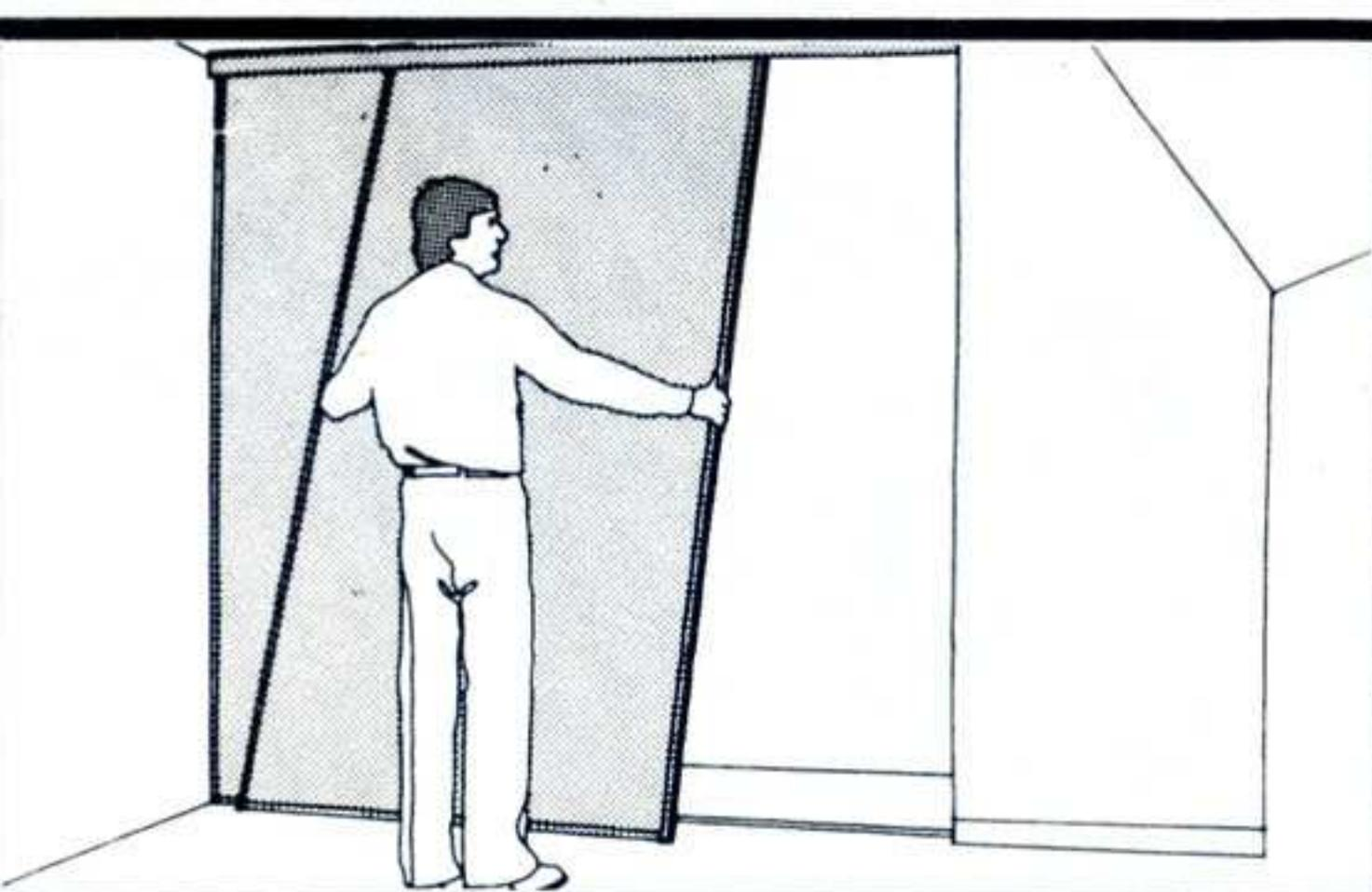
**13** **Pendez les portes.** Le bas des portes présenté avec un angle de  $15^\circ$ , faites pénétrer les galets à l'intérieur des rails et laissez les revenir à la verticale. Pour deux portes, pendez une porte sur chaque rail. Pour trois portes, pendez deux portes sur le rail arrière et une porte sur le rail avant.
